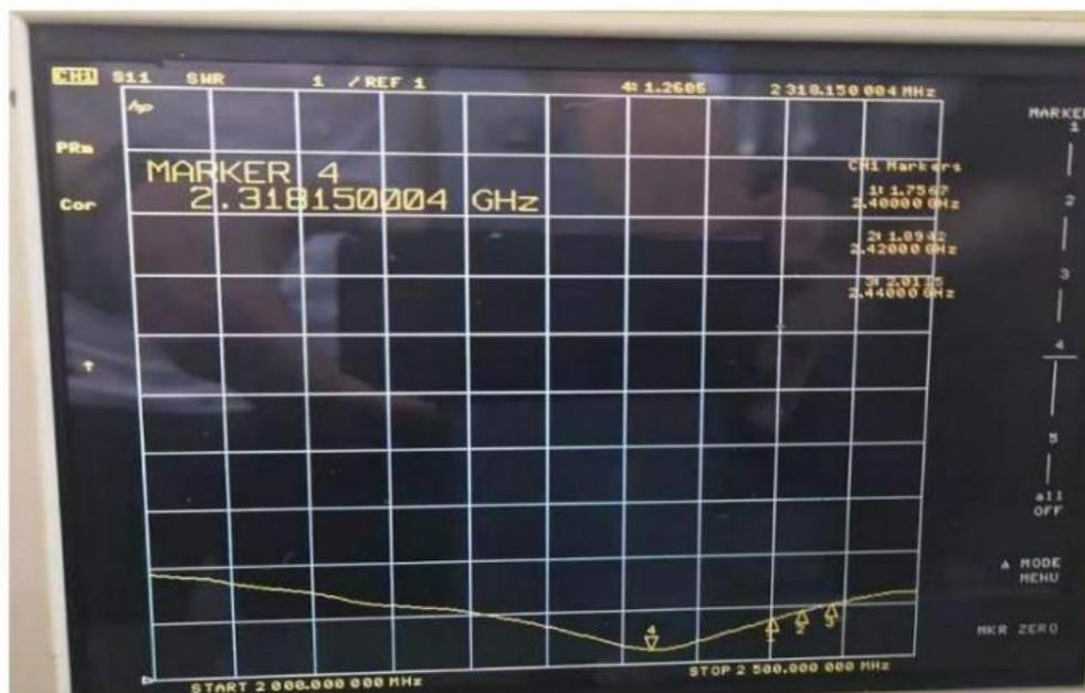
天线出厂前都经过网络分析仪在无线数据传输系统模拟环境下的严格检定。
